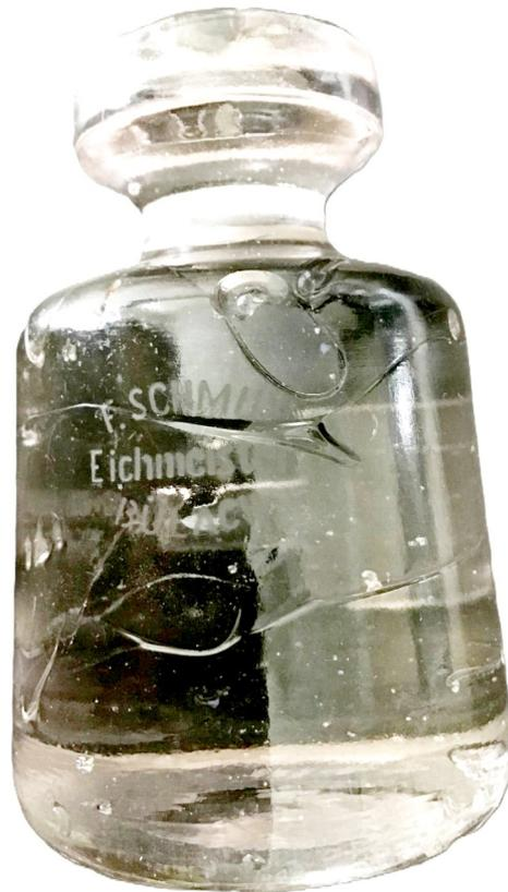
Dieses Wägestück zeigt ganz deutlich Schlieren im Glas. Es scheint, dass die beim Guss der Glaskörper entstanden sind.
