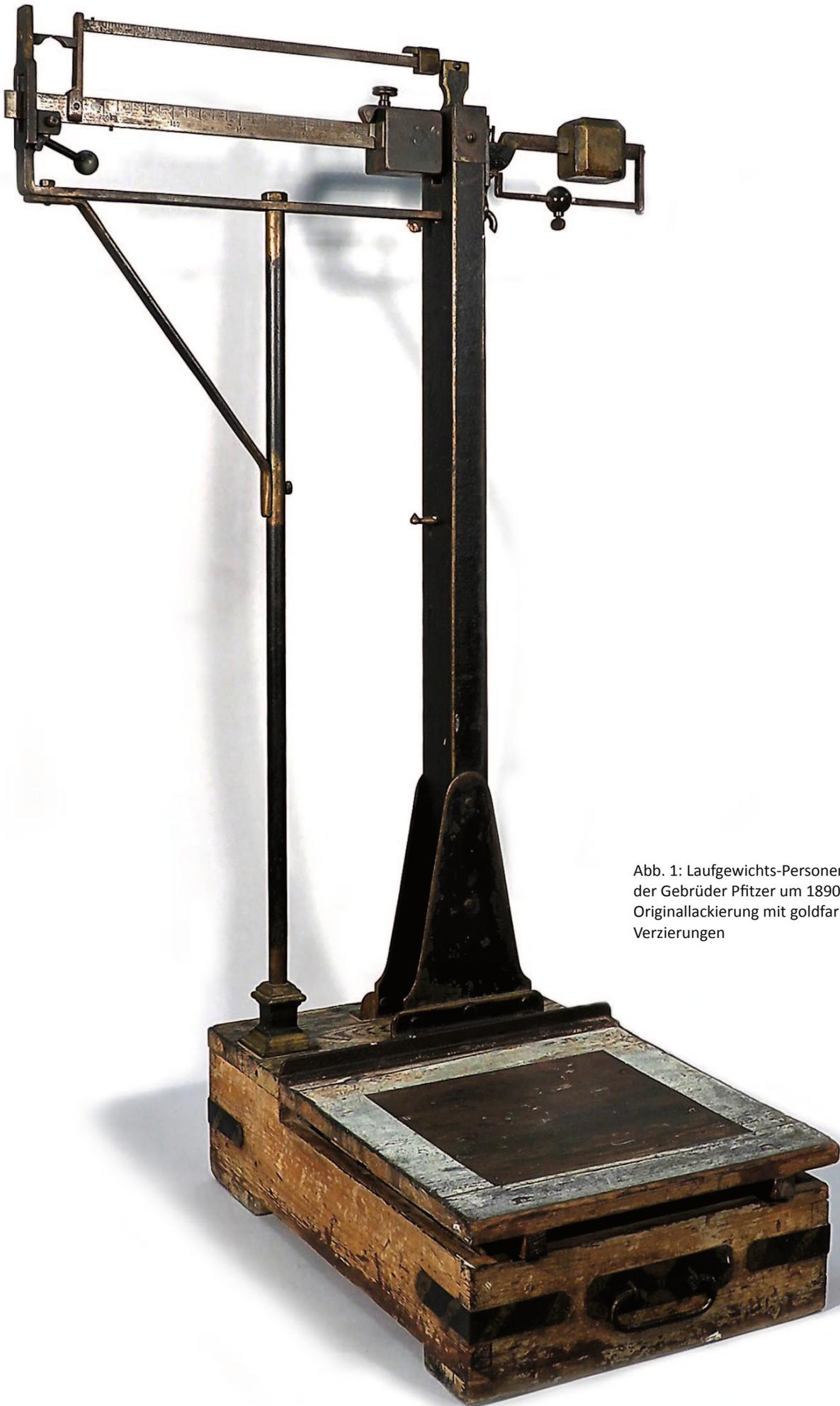
Abb. 1: Laufgewichts-Personenwaage der Gebrüder Pfitzer um 1890 in Originallackierung mit goldfarbenen Verzierungen
