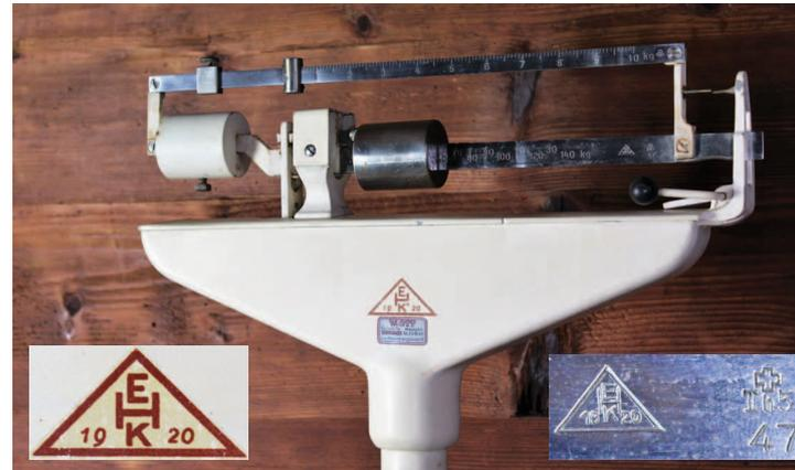
Abb. 2: Hohe Laufgewichtswaage von 1947 mit beidseitiger Balkenskalierung. Ausschnitt rechts: das ursprüngliche Markensignet auf beiden Frontplatten
