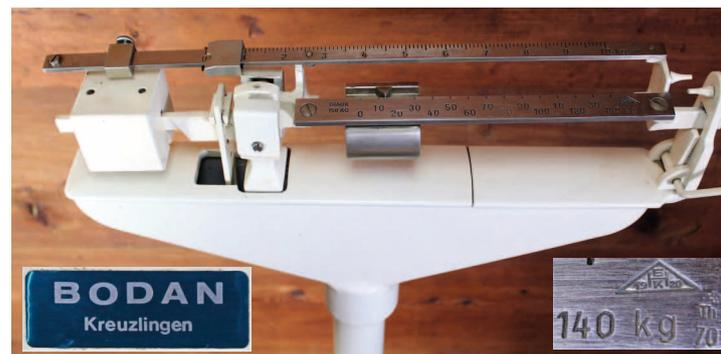
Abb. 3: Hüfthohe Laufgewichtswaage von 1970 mit oben liegender Balkenskalierung. Ausschnitt rechts: die spätere Markenbezeichnung auf der hinteren Frontplatte
